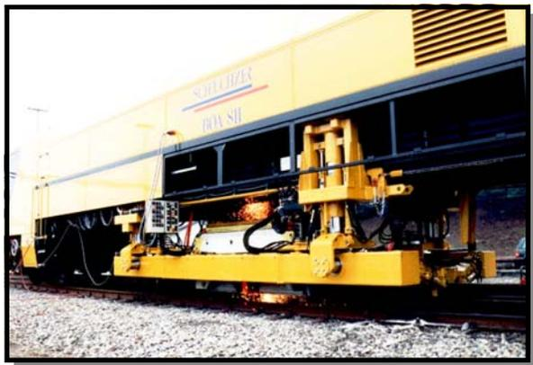
La machine de soudage 811 est mise en œuvre par 4 opérateurs :
