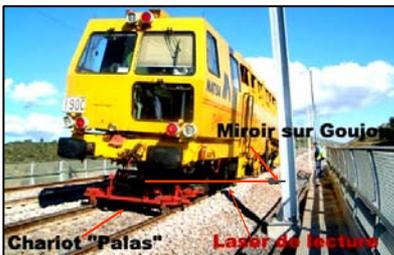
Le système existe depuis 2000 en test sur une bourreuse de type B50 MATISA. Il est adaptable sur une 109 FRAMAFAER. L'équipement est totalement intégré à l'engin. Il comprend notamment :
