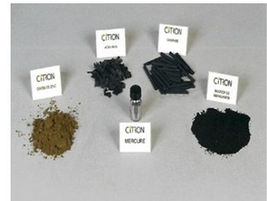
De gauche à droite : oxyde de zinc, acier inox, graphite, bioxyde de manganèse. Et au milieu : mercure
